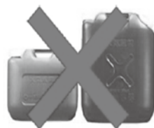
ガソリンの貯蔵に適さない容器の例（樹脂製容器は火災危険性が高い）
