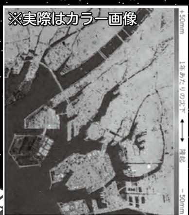
解析結果を例示した写真では、海上構造物の沈下傾向が陸地よりも大きいことが確認できます。
