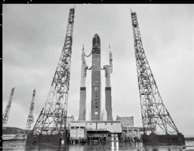
通常の打ち上げに使用するフェアリングは断熱塗料により白色をしています。今回は試験用のため塗装されていない「黒色フェアリング」となっています。
