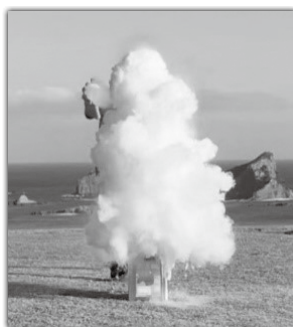
水蒸気爆発実験の様子 (カフェテリア外にて)
